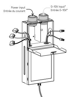
Ouvrir le couvercle de la boîte de jonction. Utiliser les connecteurs fournis et suivre les détails de connexion. Une fois la connexion terminée, refermer la boîte de jonction.
