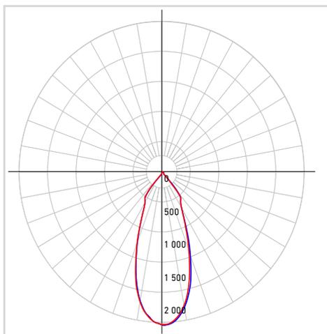
\*Puissance lumineuse mesurée à 3000K
