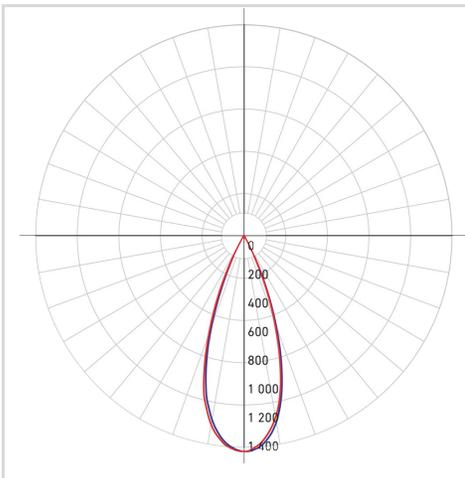
\*Puissance lumineuse mesurée à 3000K
